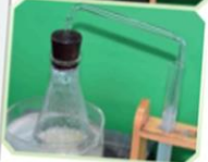
Слика 6.1.4. Добијање етанола алкохолним врењем шећера
