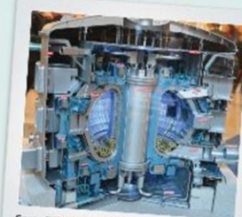
Слика 7.12. Физика уређаја на термонуклеарној фузији ITER
